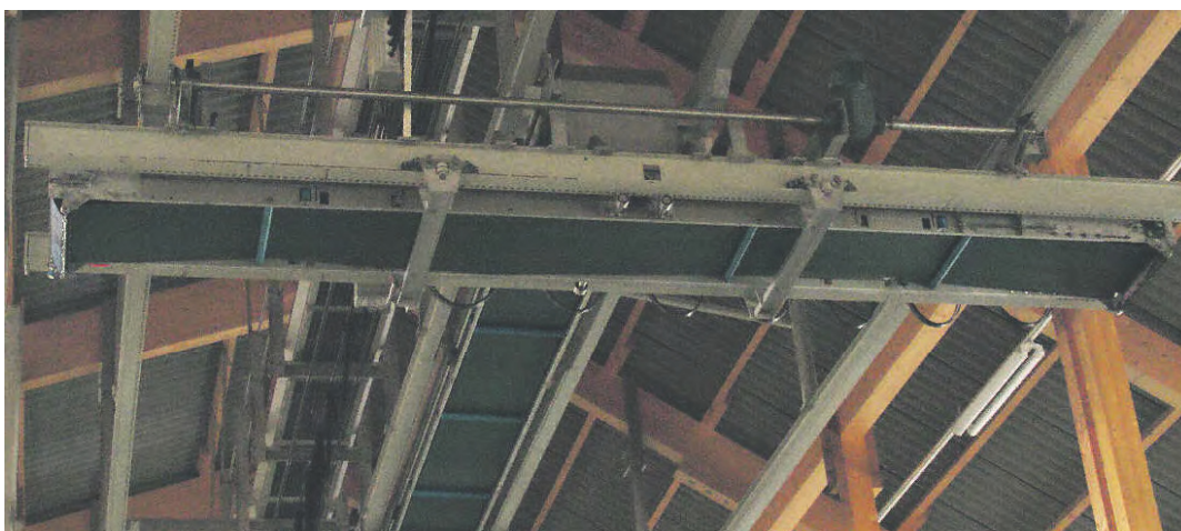
Fahrbare Förderbänder sind unterhalb des Hallendachs angebracht.
