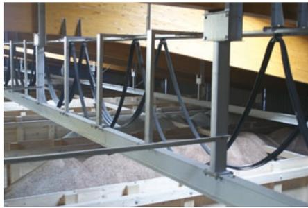
Das Schüttgut lässt sich in zahlreiche Fraktionen aufteilen, dazu kann die Förderanlage jede Lagerbox separat ansteuern und befüllen – und das nahezu vollautomatisch
