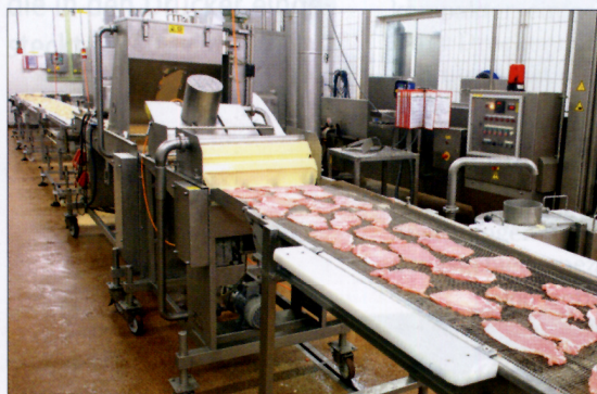
Vor dem Braten werden tausende Schnitzel über schnell zu reinigende Fördertechnik von Apullma transportiert
