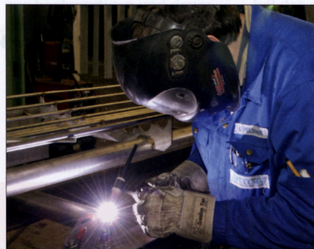
In der Summe günstiger: Rundrohrtechnik ist aufwändiger in der Konstruktion aber einfacher zu reinigen
