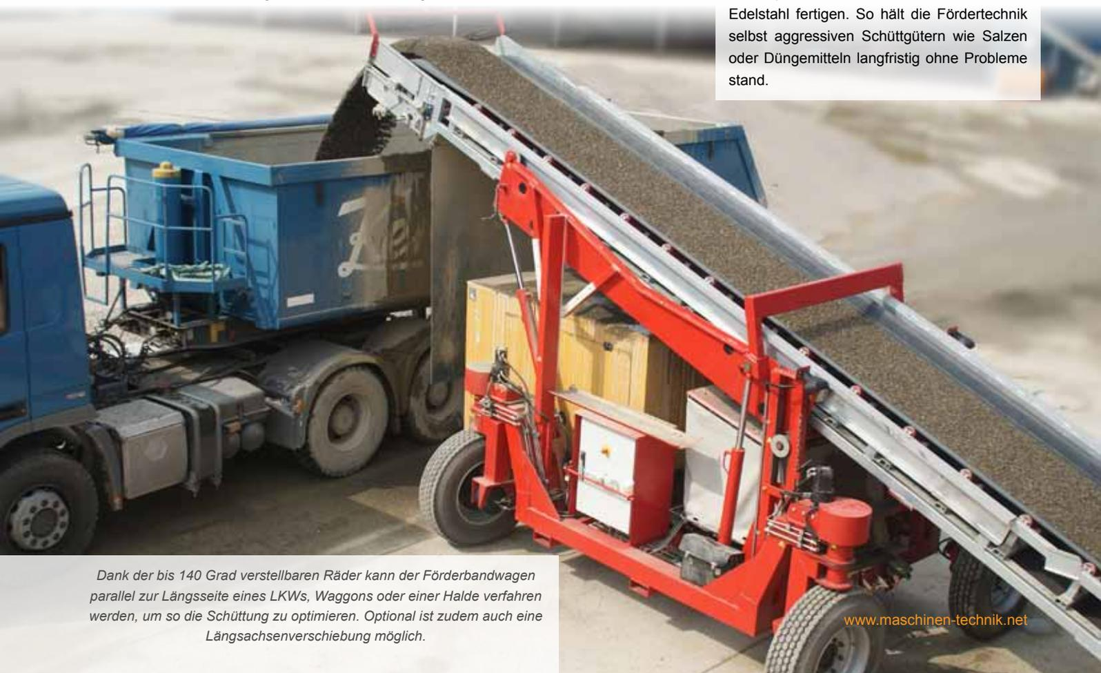
*Dank der bis 140 Grad verstellbaren Räder kann der Förderbandwagen parallel zur Längsseite eines LKWs, Waggonen oder einer Halde verfahren werden, um so die Schüttung zu optimieren. Optional ist zudem auch eine Längsachsenverschiebung möglich.*
