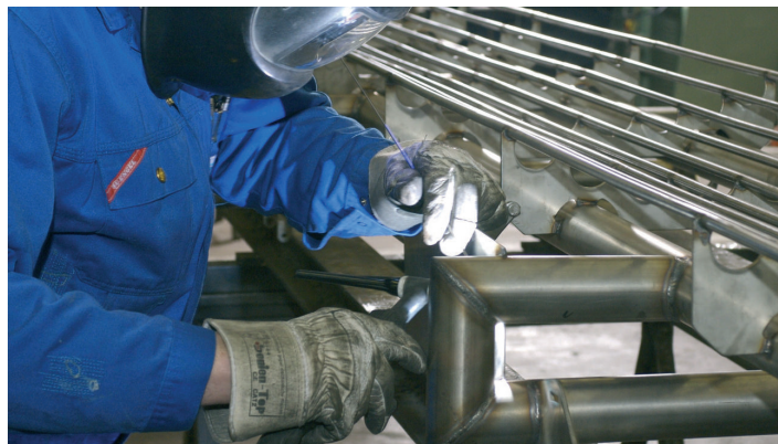
Konstruktionen aus Rundrohren sind ideal für ein reinigungsfreundliches Hygienic Design, erfordern aber eine besondere Expertise in der Verarbeitung.
