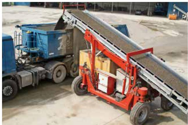
Fahrbarer Schüttgutförderer mit geländegängigem Fahrgestell zur mobilen Waggonentladung
