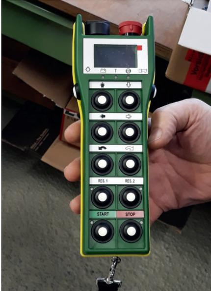
3: Über ein Handsteuergerät lässt sich der mobile Förderbandwagen einfach bedienen Foto: VLO
