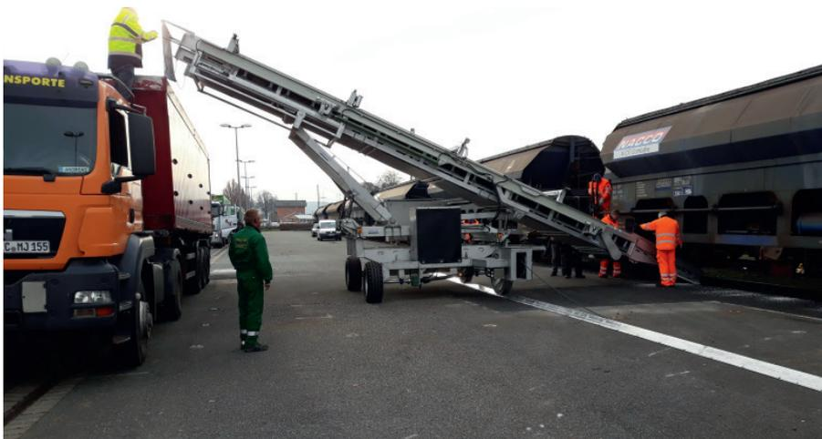
4: Über eine V-Schiene wird der Förderbandwagen zur Waggonentladung auf Spur gehalten und ist so besonders schnell verfahrbar
