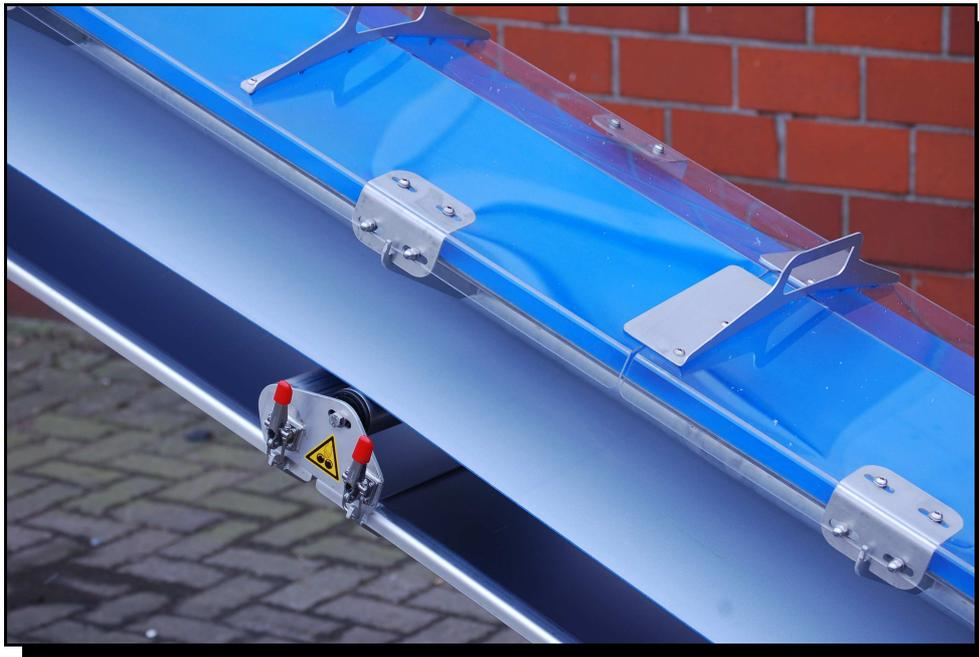
**Lutten (Oldb.) 24. November 2009** – Die Apullma Maschinenfabrik GmbH ergänzt ihre SuperClean-Förderbänder um leicht abnehmbare Hauben zum Schutz vor Fremdkörpern sowie um abklappbare Auffangwannen zur Vermeidung von Bodenverschmutzungen und erfüllt damit höchste Hygiene-Anforderungen bei der Schüttgüterförderung in der Lebensmittel- und Prozessindustrie.
