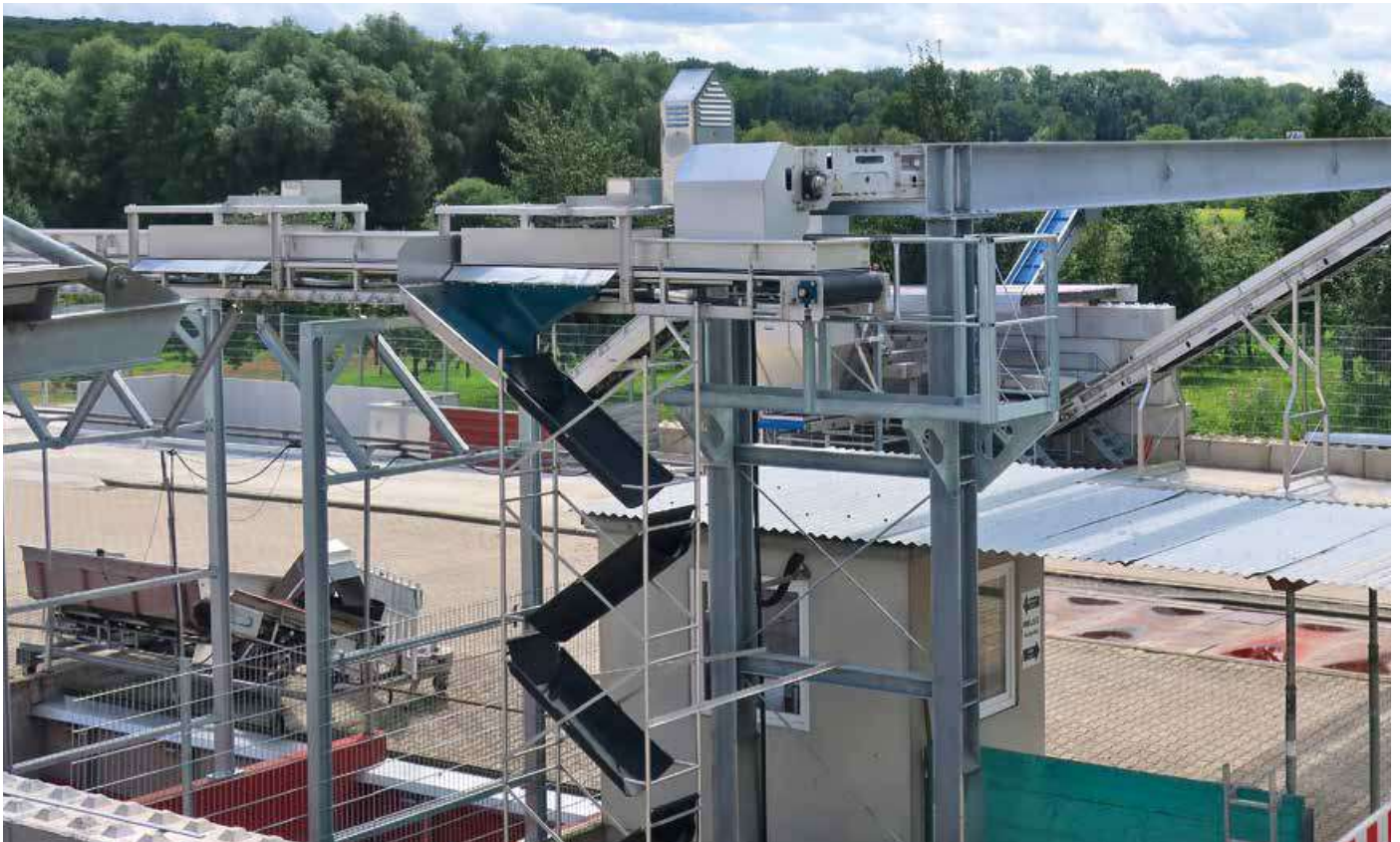
Die Ausscheider mit Fallrutschen zur Befüllung der Silos können bedarfsgerecht angesteuert werden, um beispielsweise Bio- und QZBW-Ware zu trennen (Bild entstand nach Montage der ersten Fallrutsche)
