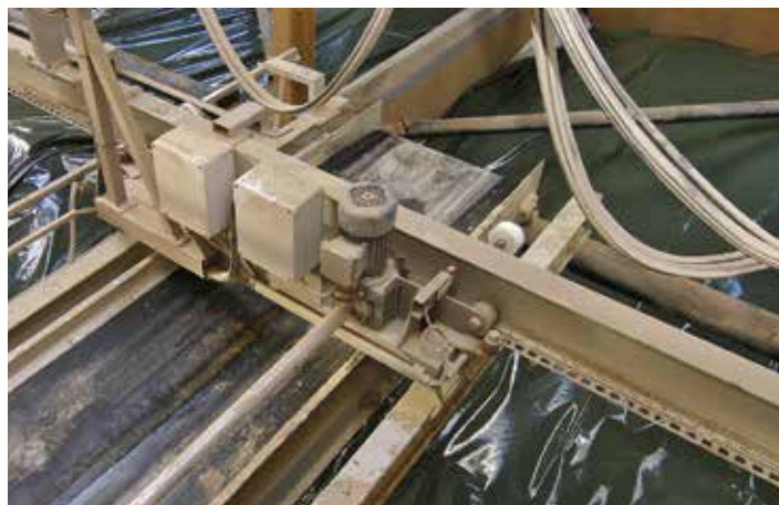
Abb. 3: Deutlich erkennbar ist das Zahnrad am Motor, das in die Lochschiene greift. Damit ist die Position des Querförderers jederzeit exakt bestimmbar. Sind die Förderer alternativ auf gummierten Rollen gelagert, ist eine aufwendigere Steuerung oder eine Steuerung nach Sicht erforderlich.
