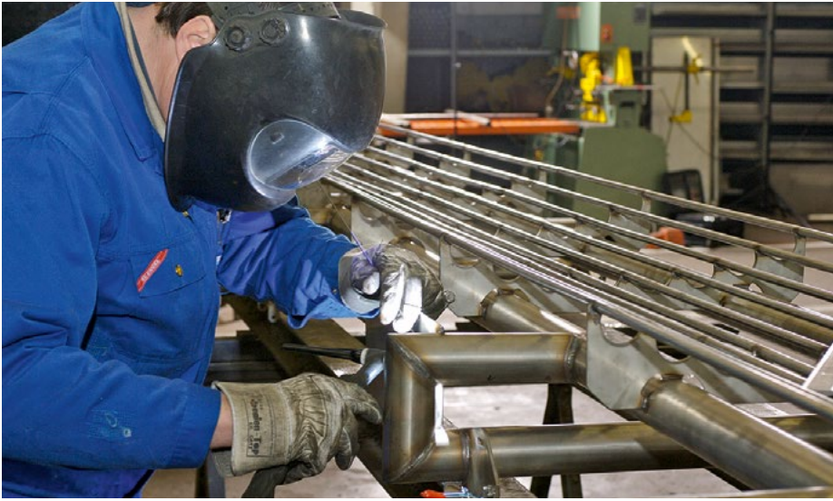
Apullmas hygienische Edelstahl-Förderer werden in Skelettbauweise gefertigt und sind filigran und robust zugleich.
